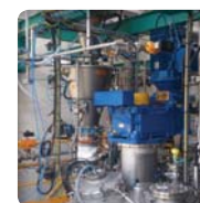
▶ Implantación en entornos difíciles: alimentación de reactores en zona explosiva: protección del filtro contra los vapores, certificación ATEX de zona de gas y polvo
