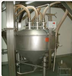
Transporte neumático por aspirado con un balance integrado de "ganancia de peso". Este modelo está especialmente diseñado para el aspirado de múltiples componentes.
