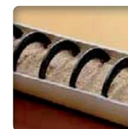
▶ **Entretien aisé** pour évacuer le produit résiduel du convoyeur en faisant tourner l'appareil dans l'autre sens.
