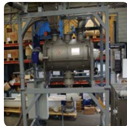
➤ Skid de mezclado para la desbacterización del polvo de algas (aplicación cosmética)
