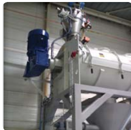
➤ Carga de la mezcladora mediante transporte neumático
