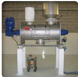
➤ Skid de mezclado de laboratorio con introducción de líquido
