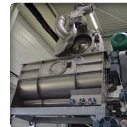
► Mezcladora integrada en una línea completa de triturado y envasado
