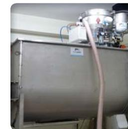
► Carga por transporte neumático en mezcladora con forma de artesa
