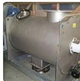
► Mezcladora de acero inoxidable cilíndrica
