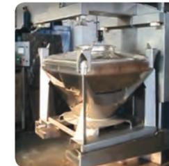
► Bloqueo de seguridad del contenedor para un proceso de mezclado sin riesgo para los operadores
