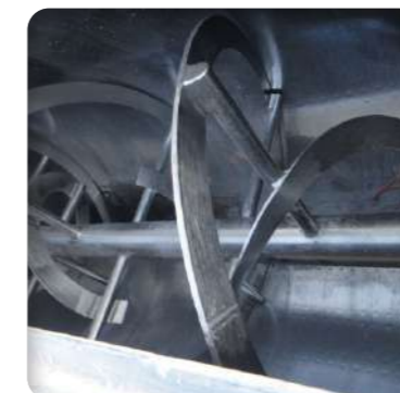
► Vista interior con cintas opuestas
