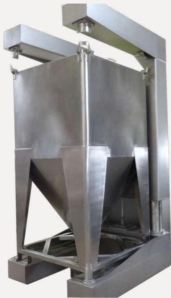
Contenedor de 2.500 litros colocado sobre la estructura de mezclado mediante una carretilla elevadora
