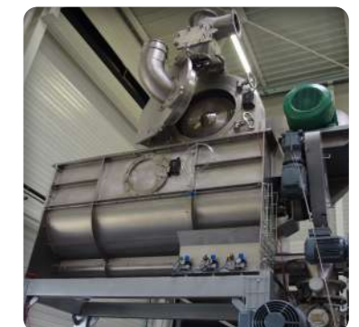
► Mezcladora integrada en una línea completa de triturado y envasado
