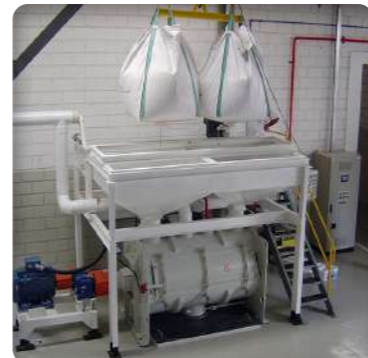
➤ Carga directa de la mezcladora con big bags
