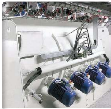
➤ Mezclado multi-choppers para la incorporación de una alta proporción de líquido
