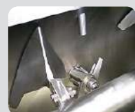
Sistema de inyección de líquidos
