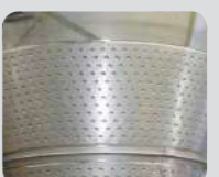
Envoltura de calentamiento/enfriamiento
