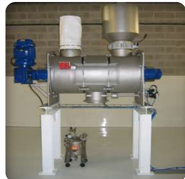
➤ Skid de mezclado de laboratorio con introducción de líquido
