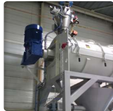
➤ Carga de la mezcladora mediante transporte neumático
