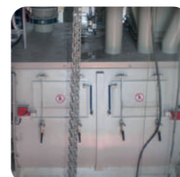
▶ Tiempos de descarga más cortos gracias a la doble boca de descarga
