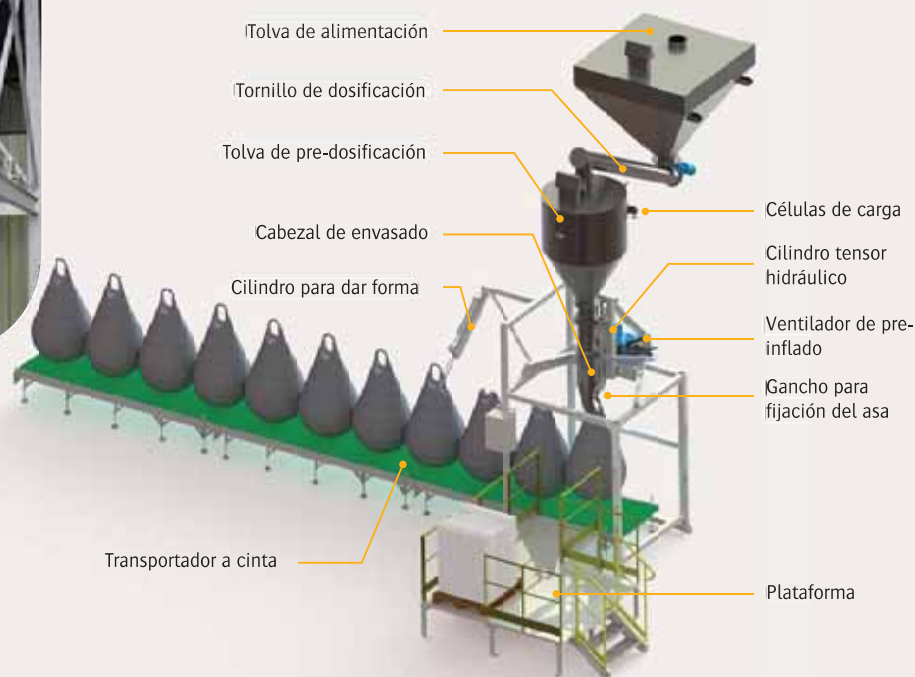
➤ Gancho tensor mediante sistema hidráulico
