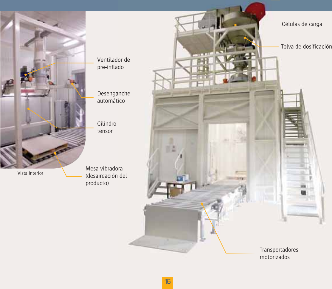
Transportador de manipulación de alta cadencia
