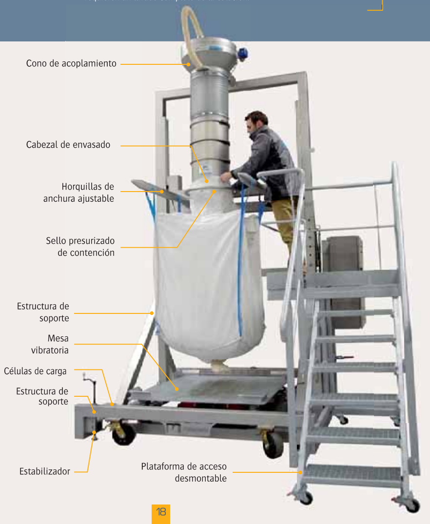
▶ Células de carga previstas para la dosificación y el pesaje comercial
