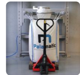
Extracción mediante carretilla elevadora o transpaleta
