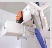
Desenganche automático del big bag
