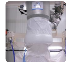
Sello presurizado que asegura la estanqueidad de la conexión
