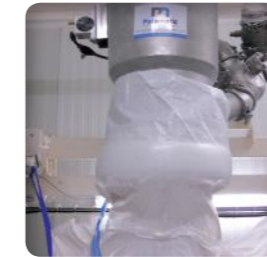
▶ Sello presurizado que asegura la contención y permite altas velocidades de llenado
