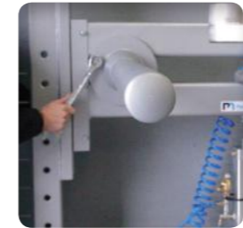
▶ Horquillas ajustables en anchura para el llenado óptimo de todo tipo de big bag
