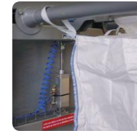
▶ Cilindro tensor que asegura un big bag perfectamente llenado y estable para su manipulación
