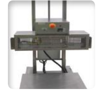
Soldador de sacos con el fin de mejorar la contención de la instalación
