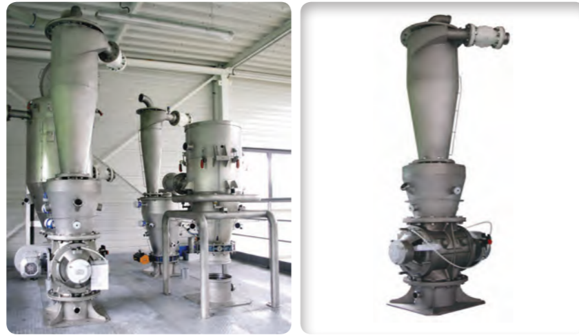
➤ Aplicación bajo filtro para garantizar la estanqueidad y la evacuación de los polvos finos aspirados
