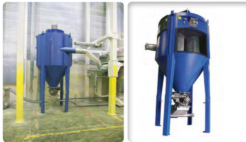
➤ Aplicación bajo filtro para garantizar la estanqueidad y la evacuación de los polvos finos aspirados
