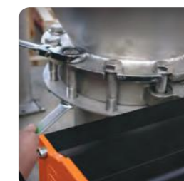
▶ Fijación por brida PN o tri-clamp para aplicaciones farmacéuticas
