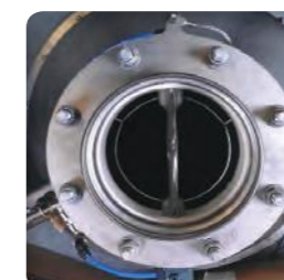
▶ Válvula perfilada para el pasaje optimizado del producto
