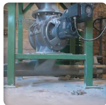
▶ Alimentación por transporte neumático
